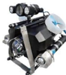
例) 漏水検出機能搭載水中ロボットカメラ
